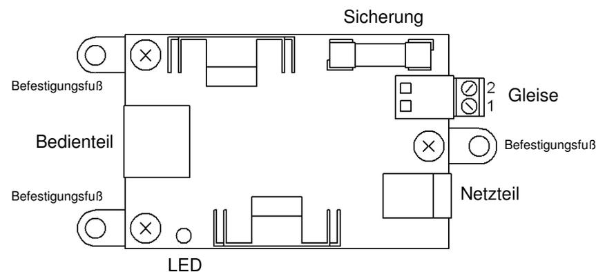
Wenn das Bedienteil ausgesteckt wird, schaltet das Leistungsteil die Ausgangsspannung aus und alle Triebfahrzeuge bleiben stehen.
