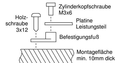
Der Einbauplatz muss so gewählt werden, dass die Luft frei an den Kühlkörpern zirkulieren kann und kein Wärmestau entsteht.
